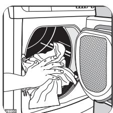
Controleer of er geen wasgoed vastzit tussen de deur en het filter.
